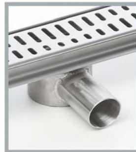
Die Duschablaufrinne muss waagrecht ausgerichtet werden. Um Dichtheit zu gewährleisten, muss der Anschluss mit einer Flüssigisolierung und die Fuge mit Silikon ausgeführt werden. Die breiten Flansche erlauben es, die Rinne optimal am Boden zu befestigen.
