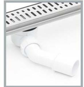
Die Duschablaufrinne muss waagrecht ausgerichtet werden. Um Dichtheit zu gewährleisten, muss der Anschluss mit einer Flüssigisolierung und die Fuge mit Silikon ausgeführt werden. Die breiten Flansche erlauben es, die Rinne optimal am Boden zu befestigen.
