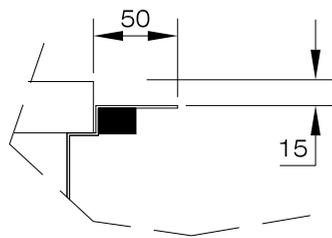
optional Fliesenabschlusskante bei Fliesenklebeflansch
