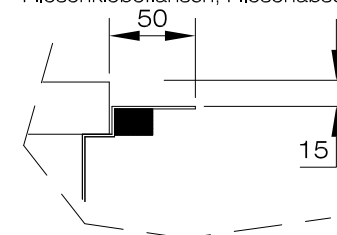
optional Fliesenabschlusskante bei Fliesenklebeflansch s=2 mm
