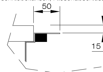
optional Fliesenabschlusskante bei Fliesenklebeflansch s=2 mm
