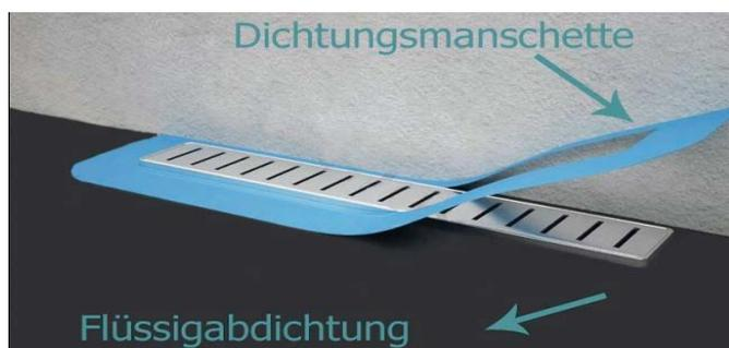
3. Zur Erhöhung der Dichtigkeit sollte der gesamte Badezimmerbereich mit einer Flüssigabdichtung versehen werden. Danach wird unsere Dichtungsmanschette angebracht und diese wiederum mit einer Flüssigabdichtung an die bestehende Abdichtung angebunden.
