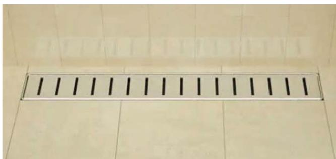
4. Nach dem Trocknen kann mit der Verfliesung des Bodens begonnen werden. Der Spalt zwischen der Entwässerungsrinne und der Fliese wird mit flexiblem Silikon in Bodenfarbe gefüllt. Achtung: Verwenden Sie keine Fugenmasse oder Epoxidsilikon. Die Fliesen neben der Rinne müssen mit Universalsilikon oder einem Kleber angebracht sein.
